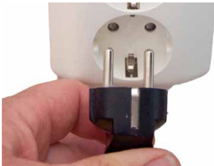
Höljet skyddar de spänningsförande delarna mot beröring. Därför får du aldrig kombinera två hankontakter om du gör en skarvsladd, för då blir stifen spänningsförande.
